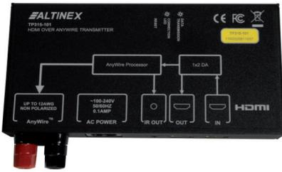
Altimex AnyWire TP315-101/102-KIT: Sender- und Empfänger-System für die Übertragung von 1080p/60Hz HDMI- und RI-Signalen bis zu 300 Metern mit einem einfachen 2-adrigen Kabel.
